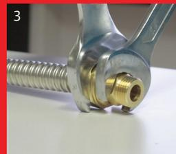
A. Raccord rapide avec filetage mâle
